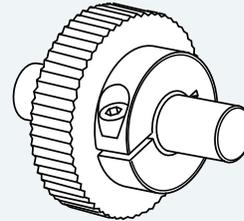
Les bagues d'arrêt fendues apportent une solution efficace pour la fixation d'éléments sur des arbres. Elles sont utilisées généralement dans des applications de tapis roulants dans l'industrie papier, l'impression et l'emballage.
