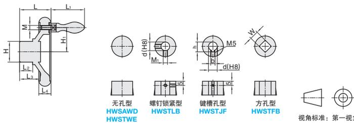
无孔型 HWSAWD HWSTWE    螺钉锁紧型 HWSTLB    键槽孔型 HWSTJF    方孔型 HWSTFB
