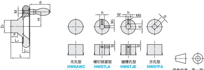
无孔型 HWSAWC HWSTWD    螺钉锁紧型 HWSTLA    键槽孔型 HWSTJE    方孔型 HWSTFA
