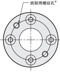
拆卸用螺纹孔\*
