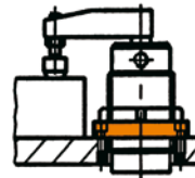
Avec bride filetée et écrou à encoches
