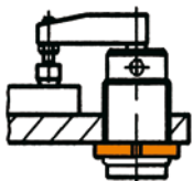
Avec écrous à encoches par le dessous
