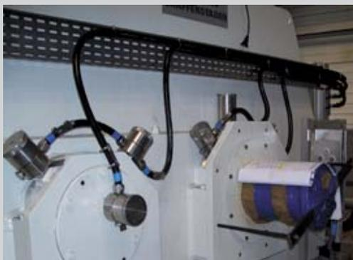
Il tipo HCl è la versione della guaina Anaconda Sealtite HC con l'anima metallica in acciaio inossidabile invece che in acciaio zincato. Per tanto oltre ad essere adatta alle alte e basse temperature come la HC, grazie al lamierino di acciaio inox, ha un'ottima resistenza alla corrosione ed ossidazione. Campi di applicazione: off-shore, acciaierie, trasformatori, impianti e macchinari in industrie chimiche, petrolchimiche ed alimentari, passaggi a livello ferroviari.
