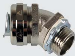
Raccordo compact NPT maschio fisso 45° in ottone nichelato (ghiera "tiger gripp" inclusa)
