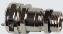
Raccordo-pressacavo ISO maschio diritto in ottone nichelato, a dop- pia tenuta, in conformità alle norme EN 45545-2, HL 1 / HL 2 / HL 3, table R22 and R23
