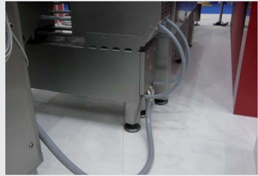
**Konstruktion** : Messing vernickelte Verschraubungen, bestehend aus 4 Teilen (Gehäuse, Einschraubhülse, PA Klemmring und Überwurfmutter).
