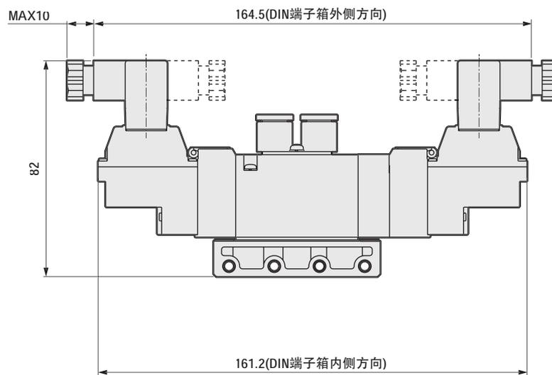
注：DIN端子箱组件向内安装发货。
