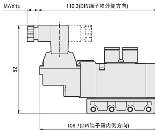
注: DIN端子箱组件向内安装发货。
