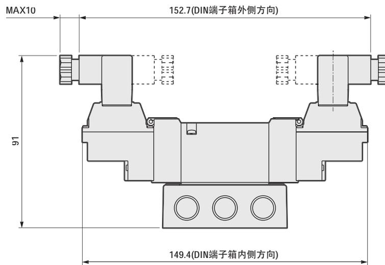
注: DIN端子箱组件向内安装发货。
