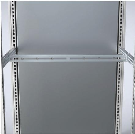
**Descripción:** Perfiles en anchura que permiten ajustar continuamente la altura, profundidad y anchura de las tuercas enjauladas de fijación. Los fabricantes de paneles pueden fijar cualquier componente en la posición deseada sin mecanizado.
