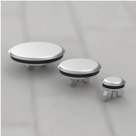
**Descripción:** Selle orificios para pulsadores adicionales, conductos y aberturas para que no entren polvo, suciedad, aceite ni agua con los tapones de Hoffman. Los tapones cubrirán orificios de cualquier forma y tamaño, desde un diámetro de 5 mm hasta el diámetro máximo indicado en la tabla. Se puede utilizar en paredes de armarios de hasta 8 mm de grosor.
