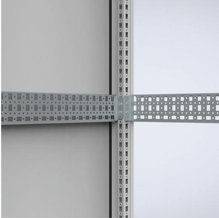
**Descripción:** Perfil universal para la profundidad o la anchura del patrón de taladros DIN de 25 mm en el marco del armario. El perfil de 75 mm de ancho cuenta con tres filas de taladros, una de las cuales está girada 90°. Esto permite montar los perfiles CLPO en ambas direcciones. Los CLPO aumentan el espacio útil en 25 mm.
