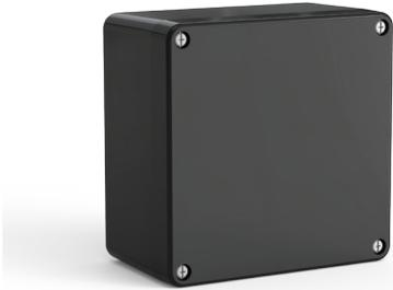
**Beschreibung:** Polyester-Klemmenkasten für erhöhte Sicherheit von Ex e-Anwendungen. Druckgeformtes, glasfaserverstärktes Polyester mit zusätzlichen Wirkstoffen zur Beseitigung von statischer Aufladung. M4- oder M6-Einsätze aus Edelstahl für DIN- und Frontplattenmontage. Die Abmessungen der Montageposition sind in die Rückseite des Gehäuses eingegossen. Abgedeckte Montageschraubenvorbereitungen außerhalb des abgedichteten Bereichs.
