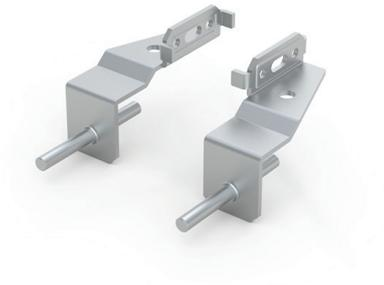
**Beschreibung:** Um zwei Montageplatten auf beliebiger Höhe im Nutzungsbereich des Schrankes aneinander zu montieren, kann die Position in Stufen von 25 mm angepasst werden. Der Abstand zwischen den Montageplatten beträgt weniger als 10 mm, wodurch dem Kunden maximaler Platz zur Verfügung steht.
