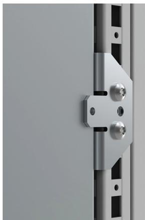
**Beschreibung:** Zur besonderen Befestigung einer schwer bestückten Montageplatte in der hintersten Position. Wird zur besonderen Stabilität an den Schrankrahmen montiert. Einfache Montage ohne zu bohren. Kann von vorne befestigt werden, nachdem die Montageplatte bereits positioniert ist. Zur Kombination mit einem Verstärkungsprofil MPR wird geraten.
