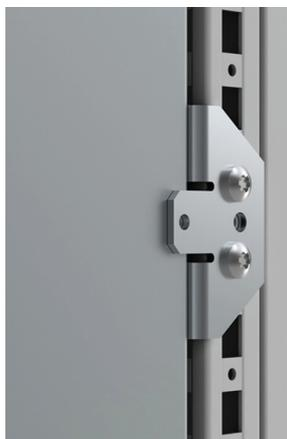
**Descripción:** Para una sujeción adicional en la posición más profunda de placas de montaje con equipo pesado. Se monta directamente sobre el marco del armario lo que da una estabilidad extra. Fácil montaje sin mecanizar. Puede montarse desde el frente incluso cuando la placa de montaje ya está en su posición. Se aconseja la combinación con un perfil MPR.
