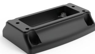
**Zusätzliche Informationen:** Der schmale Adapter kann an die Flanschkupplung und die Flansch-Winkelkupplung angeschlossen werden, um eine schmalere Verbindung zu einem Gehäuse herzustellen. Er ist speziell für den Einsatz mit den aufhängbaren HMI-Gehäusen aus Aluminium konzipiert, die 66 mm nutzbaren Raum bieten. Die Kopplungsfunktion wird nicht behindert. Aluminiumdruckgusskonstruktion. Mit Installationsanleitungen, Dichtungen und Befestigungsteilen.
