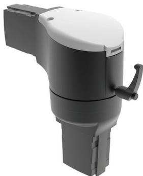
**Información adicional:** El codo giratorio proporciona una inclinación de 90 grados en el sistema de suspensión y permite que el tubo vertical gire 300 grados. Incluye tope de seguridad y rodamientos exentos de mantenimiento. Construcción en aluminio fundido. Incluye instrucciones de instalación, juntas y tornillos.
