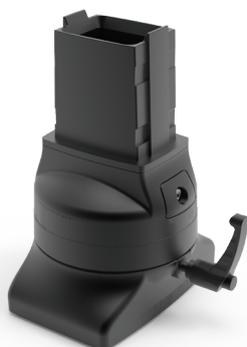
**Zusätzliche Informationen:** Die Flanschkupplung verbindet ein Rohr mit dem Gehäuse und ermöglicht so eine Gehäusedrehung um 300 Grad. Sie kann in einer bestimmten Position arretiert werden. Die Flanschkupplung ist mit einem Sicherheitsanschlag und wartungsfreien Lagern ausgestattet. Aluminiumdruckgusskonstruktion. Mit Installationsanleitungen, Dichtungen, Rohrbefestigungsschrauben und Befestigungsteilen für das Gehäuse.
