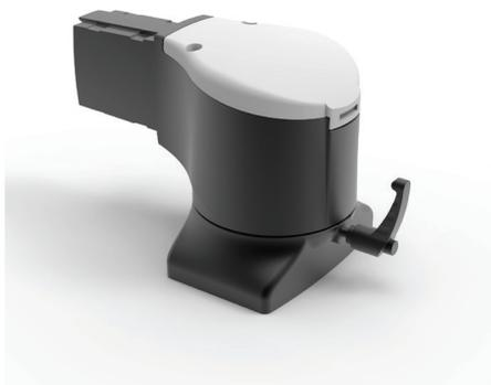
**Información adicional:** El acoplamiento acodado de brida se conecta directamente al armario en aplicaciones en las que no se necesita un tubo vertical. Permite que el armario gire 300 grados y se puede bloquear en una posición determinada. El acoplamiento acodado de brida tiene un tope de seguridad y rodamientos sin mantenimiento. Construcción en aluminio fundido. Incluye instrucciones de instalación, juntas, tornillos y componentes de montaje del armario.
