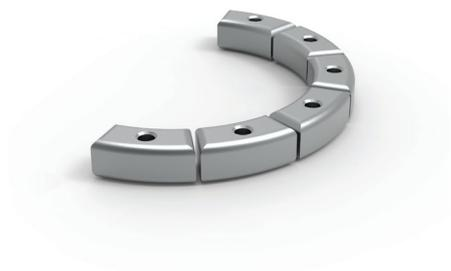
**Información adicional:** Los limitadores de rotación son una opción que se puede montar a posteriori para limitar la rotación de acoplamientos y juntas que normalmente giran un ángulo de 300 grados. Cada bloque limita la rotación 30 grados. El kit incluye seis bloques limitadores de rotación e instrucciones de instalación.
