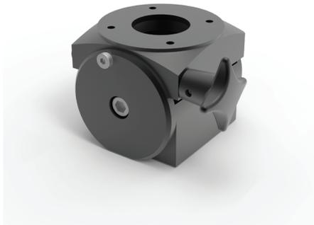
**Zusätzliche Informationen:** Der Winkeladapter muss in Verbindung mit einer Kupplung verwendet werden (nicht kompatibel mit S2MFC48). Der Gehäusewinkel kann um bis zu 30 Grad nach vorn oder hinten verstellt werden. Schwarze Oberfläche, RAL 9005. Aluminiumdruckgusskonstruktion. Mit Installationsanleitungen, Dichtung und Befestigungsteilen für das Gehäuse. Die maximale Tragkraft beträgt 30,4 kg (67 lb).
