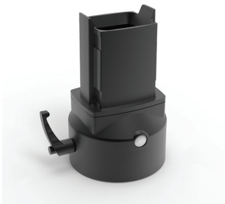
**Zusätzliche Informationen:** Die Flanschkupplung verbindet ein Rohr mit dem Gehäuse und ermöglicht so eine Gehäusedrehung um 300 Grad. Das Gehäuse kann in seiner Position arretiert werden. Die Flanschkupplung ist mit Sicherheitsanschlag und wartungsfreiem Lager ausgestattet. Schwarze Oberfläche, RAL 9005.
