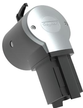
**Información adicional:** El acoplamiento acodado de soporte se conecta directamente al armario en aplicaciones en las que no se necesita un tubo vertical. Permite girar el armario un ángulo de 300 grados y bloquearlo en una posición fija. Incluye tope de seguridad y rodamiento exentos de mantenimiento. Acabado en negro RAL 9005. Construcción en aluminio fundido. Incluye cubierta de acceso al cable, instrucciones de instalación, juntas, tornillos y componentes de montaje del armario.
