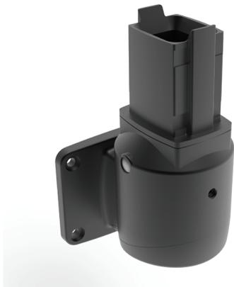
**Información adicional:** La unión de pared vertical soporta el sistema de suspensión en una superficie vertical y permite que el tubo se extienda verticalmente. Permite girar el brazo un ángulo de 300 grados. Incluye tope de seguridad y rodamiento exentos de mantenimiento. Acabado en negro RAL 9005. Construcción en aluminio fundido. Incluye una cubierta de acceso al cable extraíble, instrucciones de instalación, juntas y tornillos. No se suministran los componentes de montaje sobre superficie.
