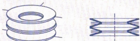
Empilage comportant quatre rondelles ressort simples
