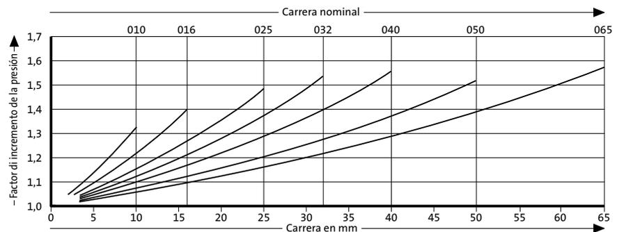
El factor de incremento de la presión es válido solamente para el desplazamiento del volumen de gas en relación a la carrera, sin otras influencias!
