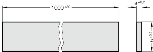
**2923.2312. Acciaio piatto di precisione e acciaio quadro con sovrametallo, DIN 59350**
