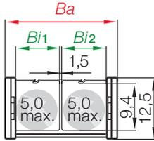
Serie E045 - im Außenradius zu befüllen mit 2-Kammersystem
