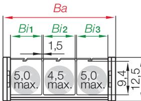
Serie E045 - im Außenradius zu befüllen mit 3-Kammersystem
