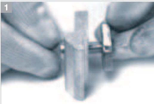
Den Klemmschuh und das Schraubenset vormontieren
