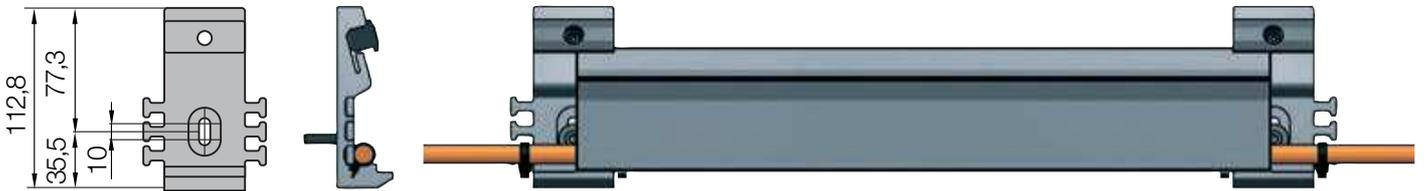
**Version 01 - kurzer Halter Art Nr. GF9.2.12** mit integrierter Zugentlastung, ± 5 mm vertikal justierbar
