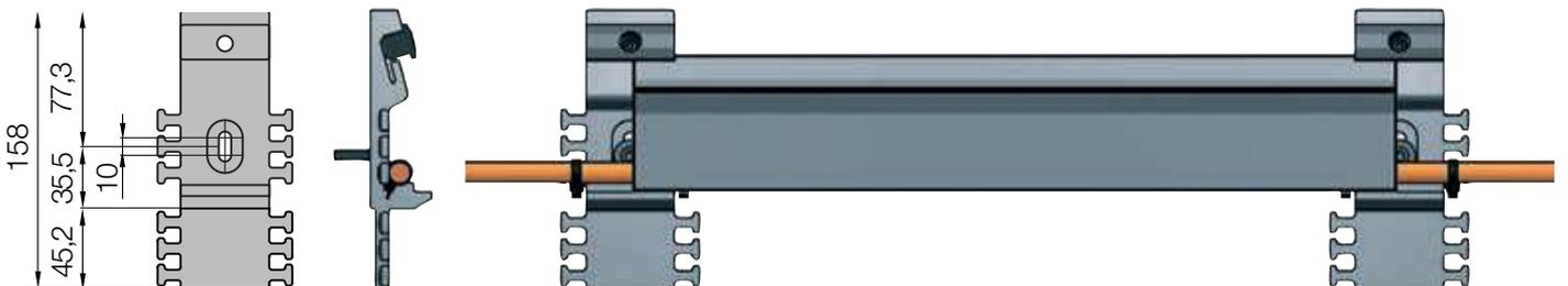
**Version 02 - langer Halter Art Nr. GF9.2.11** mit integrierter Zugentlastung, ± 5 mm vertikal justierbar
