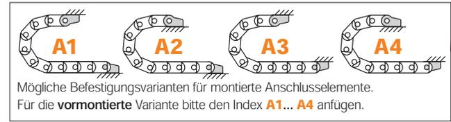
Mögliche Befestigungsvarianten für montierte Anschlüsselemente. Für die vormontierte Variante bitte den Index A1... A4 anfügen.
