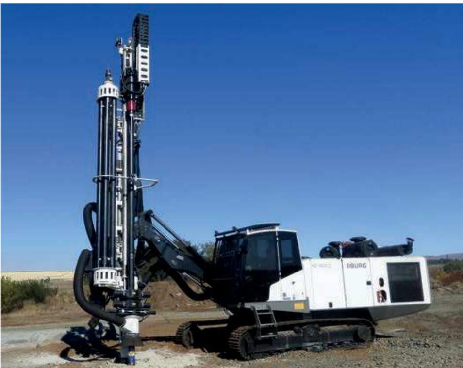
igus® E4.1 in einer Erdbohrmaschine. Stehend eingebaut, trotz der starken Vibrationen. Dank Kunststoff, keine verlierbaren Teile wie Nieten oder Schrauben
