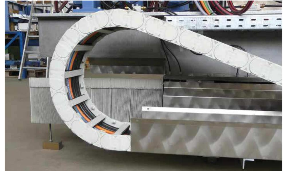
igus® e-ketten® trotzen den harten Bedingungen auch in Steinbearbeitungsanlagen. Aufgabe der e-kette® ist die Versorgung des Werkzeugschlittens mit Energie (bis zu 100 A), Signalen, Druckluft und Wasser. Sie erreicht Verfahwege von bis zu zwölf Metern und verfährt im Rücklauf mit Geschwindigkeiten von bis zu 32 m/min.
