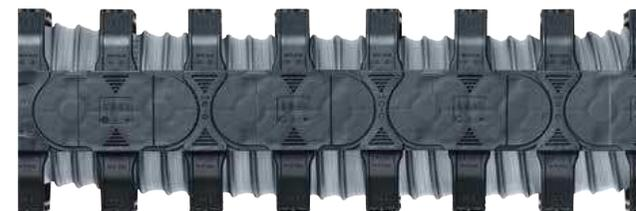
Die E4.1 lässt sich durch aufklappbare Bügelöffnungsstege erweitern, welche den Innenraum der e-kette® vergrößern. Die Stege können auf verschiedene Art montiert werden: Einseitig, beidseitig, alternierend mit normalen Öffnungsstegen und Kombinationen aus diesen Möglichkeiten
