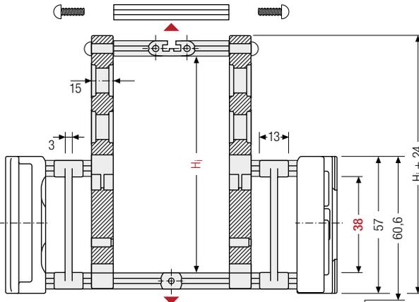
**i** Der maximale Leitungsdurchmesser ist stark abhängig vom Krümmungsradius und dem gewünschten Leitungstyp. Bitte sprechen Sie uns an.
