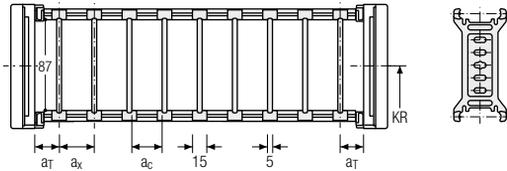
Die Trennstege sind im Querschnitt verschiebbar (Version A) oder fixiert (Version B).
