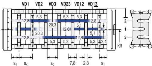
Die Trennstege sind im Querschnitt verschiebbar (Version A) oder fixiert (Version B).
