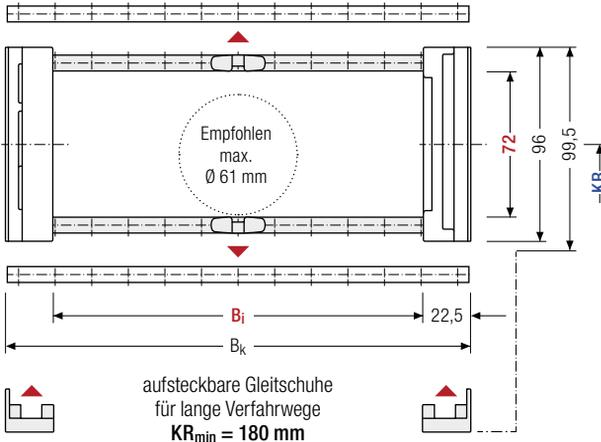
Der maximale Leitungsdurchmesser ist stark abhängig vom Krümmungsradius und dem gewünschten Leitungstyp. Bitte sprechen Sie uns an.
