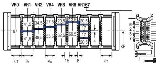
Mit Rasterunterteilung (1 mm Raster). Die Trennstege sind durch die Höhenunterteilung fixiert, das Raster ist im Querschnitt verschiebbar.
