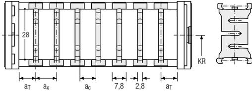
Die Trennstege sind im Querschnitt verschiebbar (Version A) oder fixiert (Version B).
