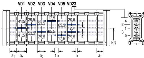
Die Trennstege sind im Querschnitt verschiebbar (Version A) oder fixiert (Version B).
