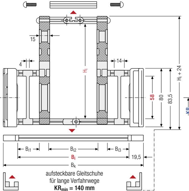
**i** Der maximale Leitungsdurchmesser ist stark abhängig vom Krümmungsradius und dem gewünschten Leitungstyp. Bitte sprechen Sie uns an.
