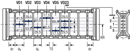
Die Trennstege sind im Querschnitt verschiebbar (Version A) oder fixiert (Version B).
