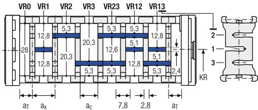
Mit Rasterunterteilung (8 mm Raster). Die Trennstege sind durch die Höhenunterteilung fixiert, das Raster ist im Querschnitt verschiebbar (Version A) oder fixiert (Version B).
