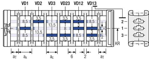
Die Trennstege sind im Querschnitt verschiebbar.
