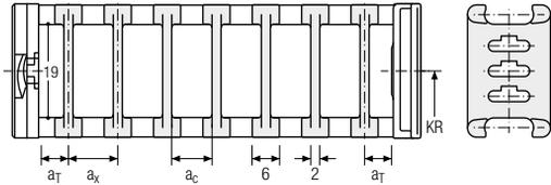
Die Trennstege sind im Querschnitt verschiebbar.
