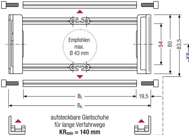
Der maximale Leitungsdurchmesser ist stark abhängig vom Krümmungsradius und dem gewünschten Leitungstyp. Bitte sprechen Sie uns an.
