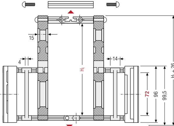
**i** Der maximale Leitungsdurchmesser ist stark abhängig vom Krümmungsradius und dem gewünschten Leitungstyp. Bitte sprechen Sie uns an.
