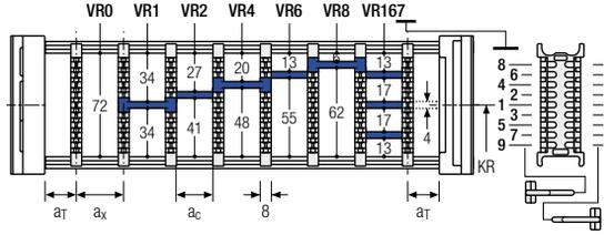
Die Trennstege sind durch die Zwischenböden fixiert, das komplette Trennstegsystem ist im Querschnitt verschiebbar.
