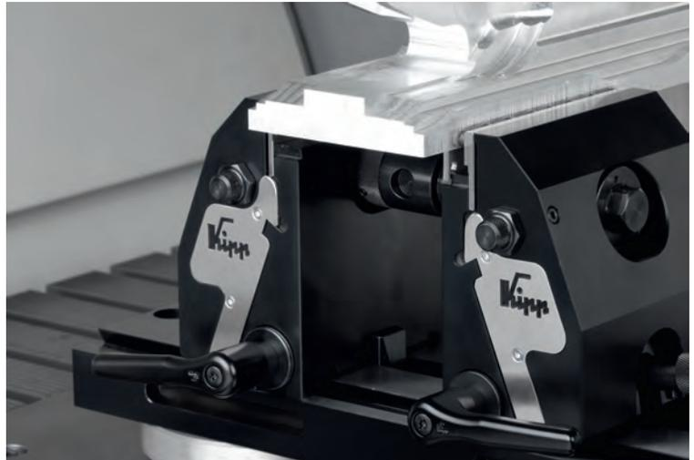
Rohteil im gespannten Zustand. Sichere Aufspannung durch formschlüssige Spannpins.
