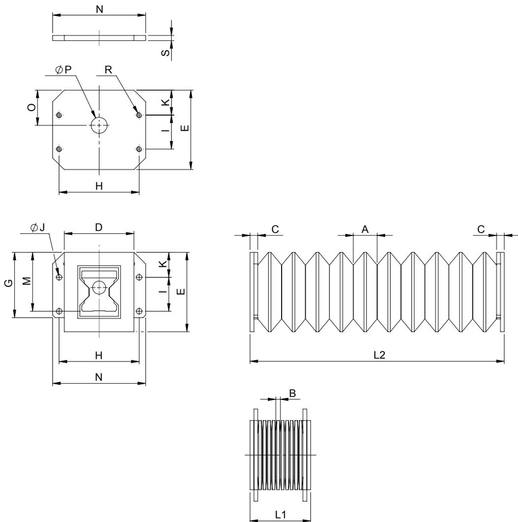
**!** Prüfen Sie, ob die Betriebsbedingungen einen Zahnstangenschutz erfordern. Dieser Zahnstangenschutz ist **für den Einsatz im Schweißbereich geeignet**. Er wird mit Halteplatten und Schrauben geliefert.
