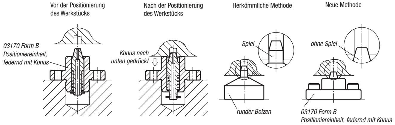
Beim Auflegen des Werkstücks auf die Positioniereinheit wird der Konus nach unten bewegt.
