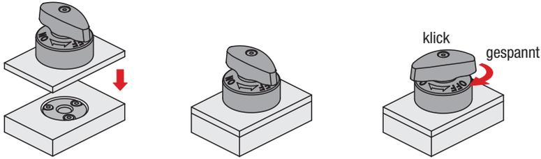
Sicherstellen, dass der Drehkopf auf Position „OFF“ steht.
