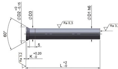
**Esecuzione:** Gambo del punzone finemente rettificato e lappato, testa ribattuta a caldo e rinvenuta. L'ingrossamento del collo "D3" sotto la testa, dovuto alla ribattitura, è generalmente inferiore a quanto prescritto dalla norma DIN 9861.
