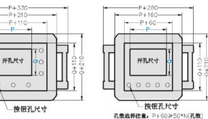
面板箱后面开门,前面为触摸屏和按钮安装板,两侧带把手
