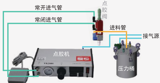
●DPK-2000复动点胶机+压力桶+点胶阀配套接线图
