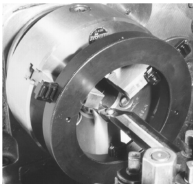
Innen-Ausdrehen von ungehärteten Backen
