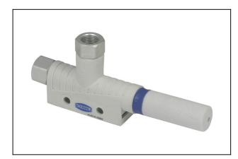
Düsengröße: 1,0 mm mit: axialem Schalldämpfer Evakuierungsgrad: 85 % Anschluss: G1/8"(1)-G1/8"(2) Opt. Betriebsdruck: 4.5 bar Saugvermögen (max): 37 7 l/m
