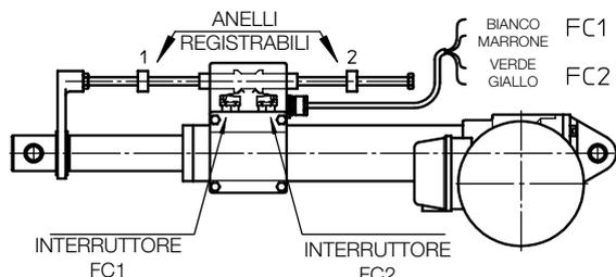
Due interruttori elettrici, alloggiati all'interno di una scatola di plastica, sigillata ed a tenuta, vengono azionati da due anelli registrabili, attraverso un cannotto forato.
