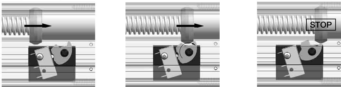
Gli interruttori standard hanno contatti argentati, corrente max 12 A con carico resistivo - 6 A con carico induttivo. A richiesta, sono disponibili interruttori con contatti dorati, con bassissima resistenza di contatto per bassa tensione di lavoro (quando collegati con PLC oppure PC), corrente max 0.1 A.
