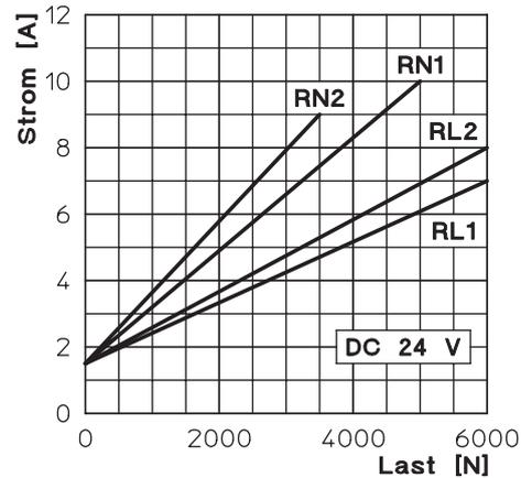
Leistungen mit 12 V Gleichstrommotor: bei gleicher Last - Hubgeschwindigkeit 10 % reduziert, Stromaufnahme verdoppelt
