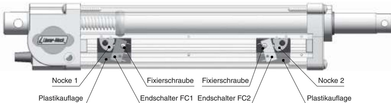
Folgende Bilder zeigen eine Schaltfunktion eines FC2 Endschalters.
