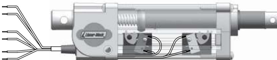
Bestellcode **FC2X**: zwei mit Nocken aktivierte elektrische Endschalter, intern mit dem Motor angeschlossen, um diesen direkt abzuschalten
