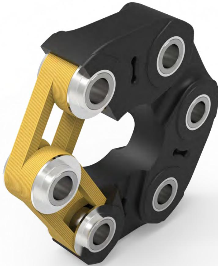
Das SGF-Zugkraftprinzip sorgt dafür, dass Drehmomente fast ausschließlich durch die einvulkanisierten Fadenpakete als Zugkraft übertragen werden.
