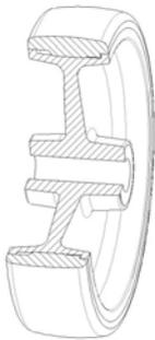
**Rivestimento:** in gomma termoplastica grigia termoindurente, durezza 85+/-4 Shore A, ottime caratteristiche di scorrevolezza ed elasticità.
