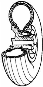
**Rivestimento:** in gomma pneumatica rigata, pressione d'esercizio 2 bar.
